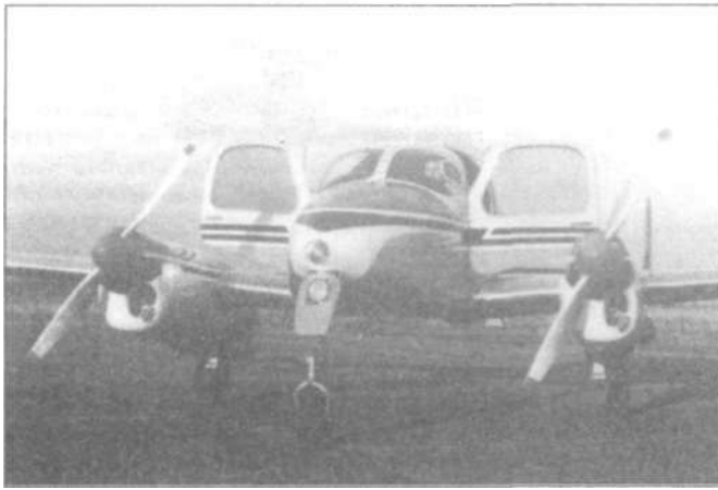
Широкие двери кабины L-200A позволяли пассажирам занимать свои места как в автомобиле.
