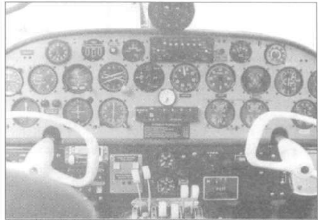
Интерьер кабины самолета с двойным управлением.
